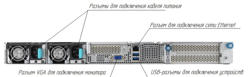
Рисунок 1 – Подключение сервера (расположение, внешний вид, типы разъемов и их количество может отличаться от приведенного)
